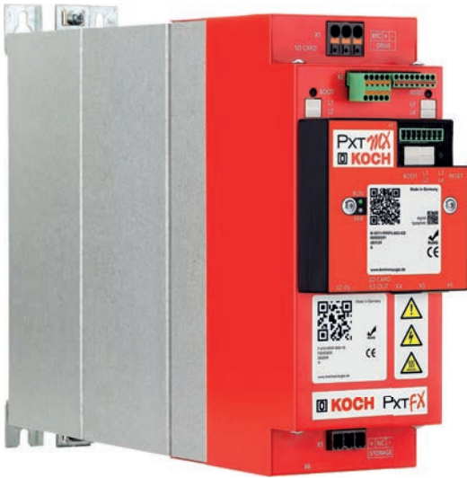
Bild 2. Das kleine schwarze Kästchen macht den Unterschied: Das Modul ‚PxtMX‘ ermöglicht eine Lastspitzenreduzierung per Plug&Play. Dafür wird das Modul auf das aktive Energiemanagement-Gerät ‚PxtFX‘ gesetzt. Es entsteht eine Einheit mit 4 kJ Energie zur automatischen Lastspitzenreduzierung bei kleinen Leistungsanforderungen.
