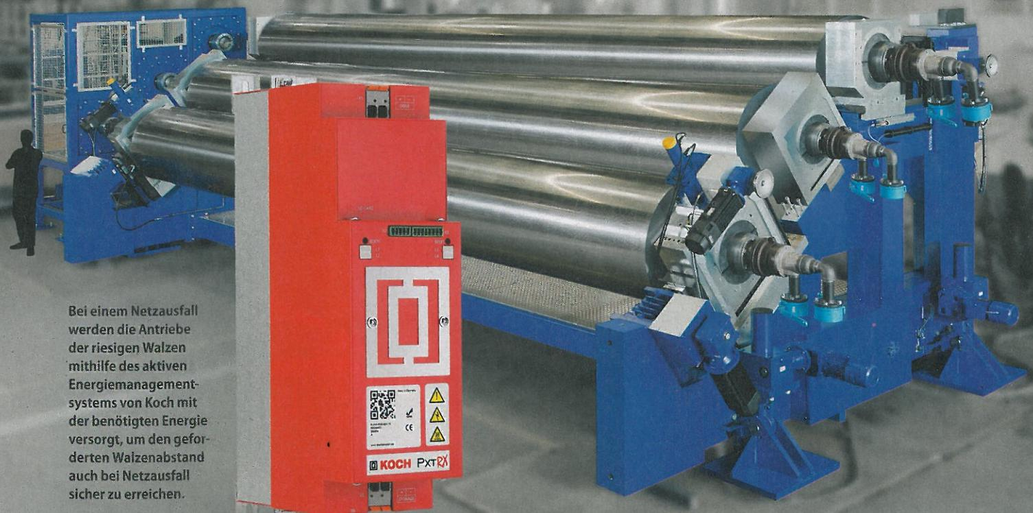
Bei einem Netzausfall werden die Antriebe der riesigen Walzen mithilfe des aktiven Energiemanagementsystems von Koch mit der benötigten Energie versorgt, um den geforderten Walzenabstand auch bei Netzausfall sicher zu erreichen.
