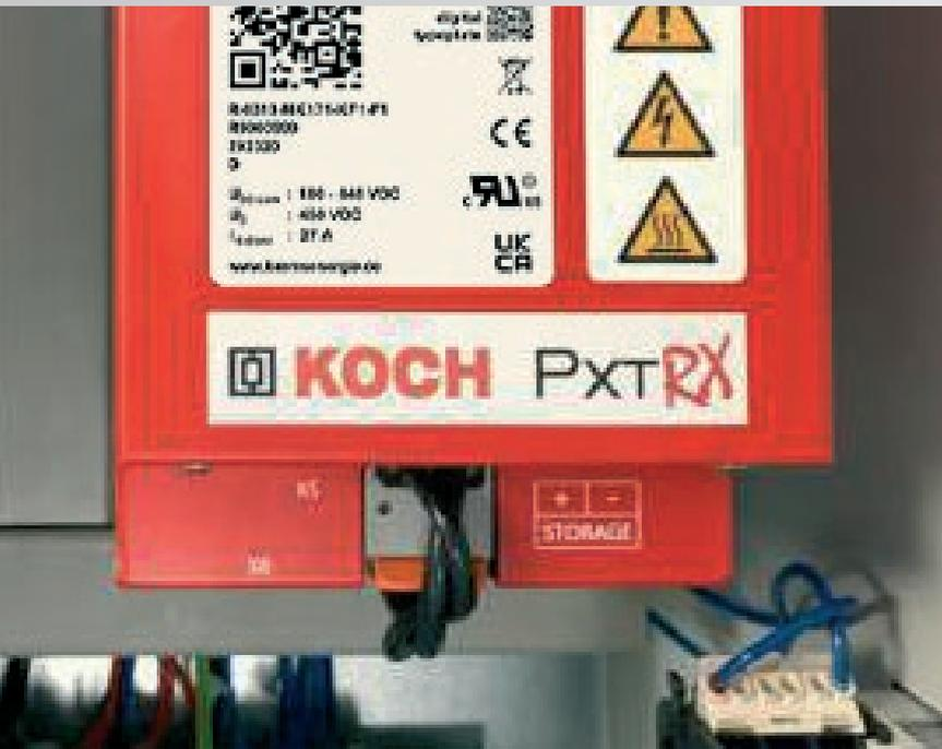
Noch schneller geht es mit dem Dynamischen Entlade-Manager DDM, der in Verbindung mit dem PxrRX über einen externen sicheren Bremswiderstand mit einer linearen Entladekurve dafür sorgt, dass die Energien großer Doppelschichtkondensator-Systeme in sehr kurzer Zeit entlädt.
